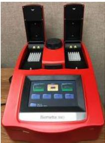
= **Thermocycleur** (appareil faisant juste des variations de température de manière très rapide, en quelques secondes) : c'est lorsqu'on ouvre ce tube que notre ADN alors très volatile peut s'échapper et contaminer les échantillons suivants.
