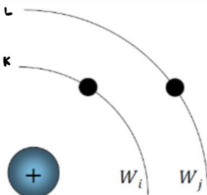
On décrit l'atome selon le **modèle de Bohr** (ci-contre), ce modèle est une description simple de l'atome, avec des électrons qui sont répartis sur différentes couches électroniques (K, L, M, N ou i, j, k... selon cet exemple)
