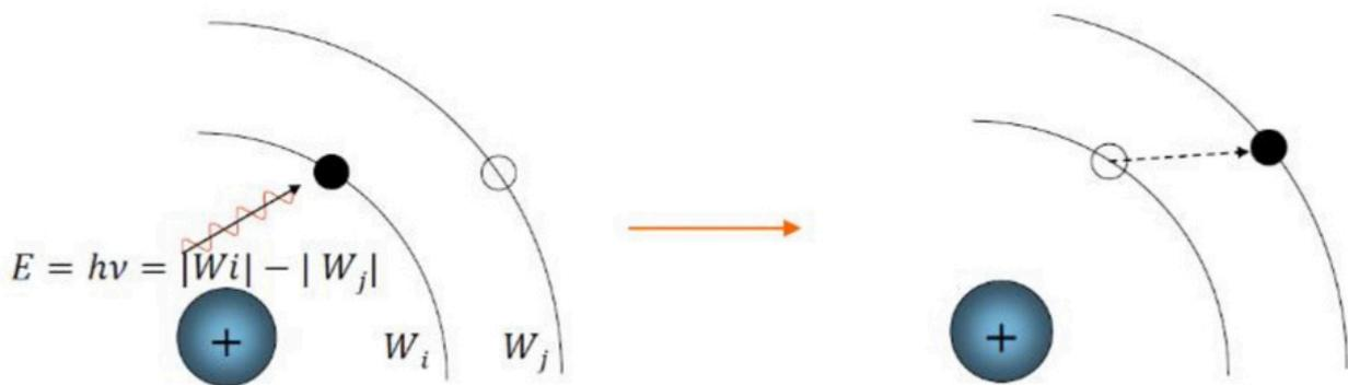
(On voit donc sur ce petit schéma, que l'énergie du photon incident est bien égale à la différence d'énergie de *liaison* des électrons sur la couche **i** et **j**. Donc l'électron va être excité et va passer de la couche **i** à la couche **j**).
