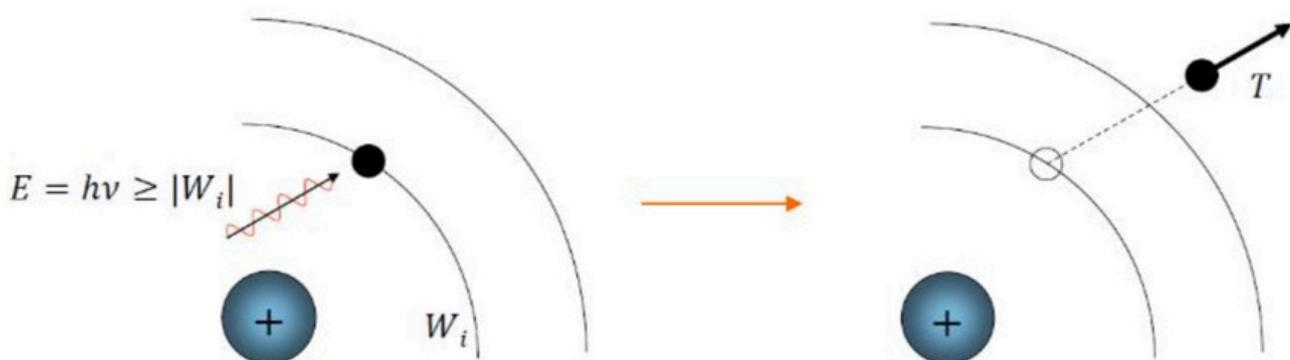
(On voit bien que l'énergie du photon incident est bien supérieure à l'énergie de liaison de l'électron sur la couche  $i$ . Donc l'électron va être *ionisé (expulsé)* et va complètement partir de sa couche électronique, avec une énergie cinétique  $T$ ).
