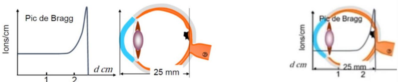
Autre exemple avec la protonthérapie de haute énergie, avec des protons de  $230 \text{ MeV}$  pour le traitement de tumeurs plus profondes. On voit la comparaison avec d'un côté les photons qui ont un dépôt d'énergie trop large, avec des dépôts également en avant et en arrière de la tumeur, et de l'autre côté les protons qui sont plus ciblés, avec un faible dépôt en avant de la tumeur et aucun dépôt en arrière, ce qui permet de mieux *préserv*er les tissus sains.
