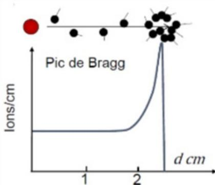
On voit ainsi sur ce schéma le nombre d'ionisations effectuées selon la distance, et on voit qu'il existe un **Pic de Bragg**, qui correspond à une augmentation brutale de la concentration des ionisations au moment où la vitesse diminue, avec une *chute* brutale des ionisations à partir d'une certaine distance, lorsque la totalité de l'énergie de la particule a été consommée.
