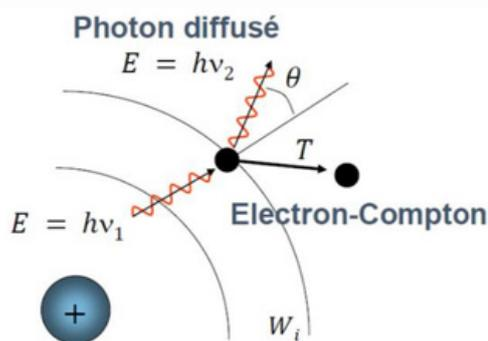
Cela correspond à un **transfert PARTIEL** de l'énergie du photon incident à un **électron dans la matière** (électron faiblement lié). L'énergie incidente se répartit alors entre **l'énergie cinétique de l'électron-Compton émis**, **l'énergie consommée pour l'arracher** (énergie de liaison), et **l'énergie du photon diffusé** (dévié) :
