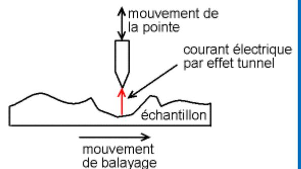
Une pointe très fine alimentée électriquement peut arracher par effet tunnel les électrons du métal, en mesurant le courant électrique qui passe dans la pointe, on peut reconstituer où se trouvent les atomes et tracer leur position.
