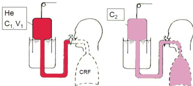
1) **Injection** d'hélium dans la cloche (**Vd<sub>1</sub>**) alors que la personne ne respire pas encore ; on a une concentration **C1**.
