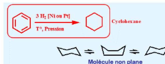
L'hydrogénation d'un benzène se fait en présence de **3 molécules d' $H_2$**  sous catalyseur solide (Pt ou Ni), avec chauffage et pression → **cis-addition**
