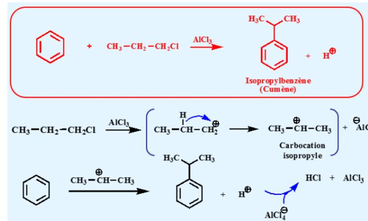
La réaction du **benzène** avec un **chloropropane** formera un **isopropylbenzène (=cumène)** et un proton.
