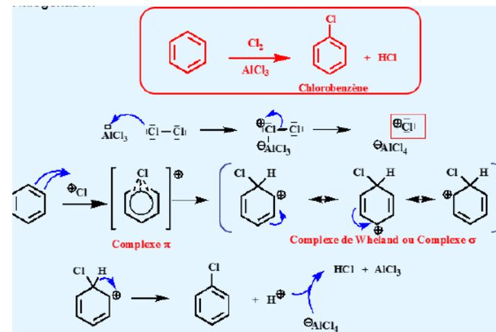
Pour la chloration, on utilise le **trichlorure d'aluminium** (AlCl<sub>3</sub> = **acide de Lewis**) comme catalyseur, pour passer par un **mécanisme ionique** → et former Cl<sup>+</sup>.
