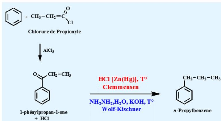
2 réactions de réductions sont possibles pour obtenir le n-propylbenzène :
