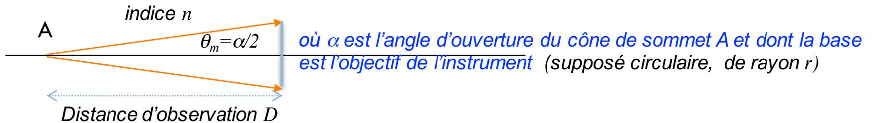
d) On définit l'**ouverture numérique** (*numerical aperture*) d'un instrument :
