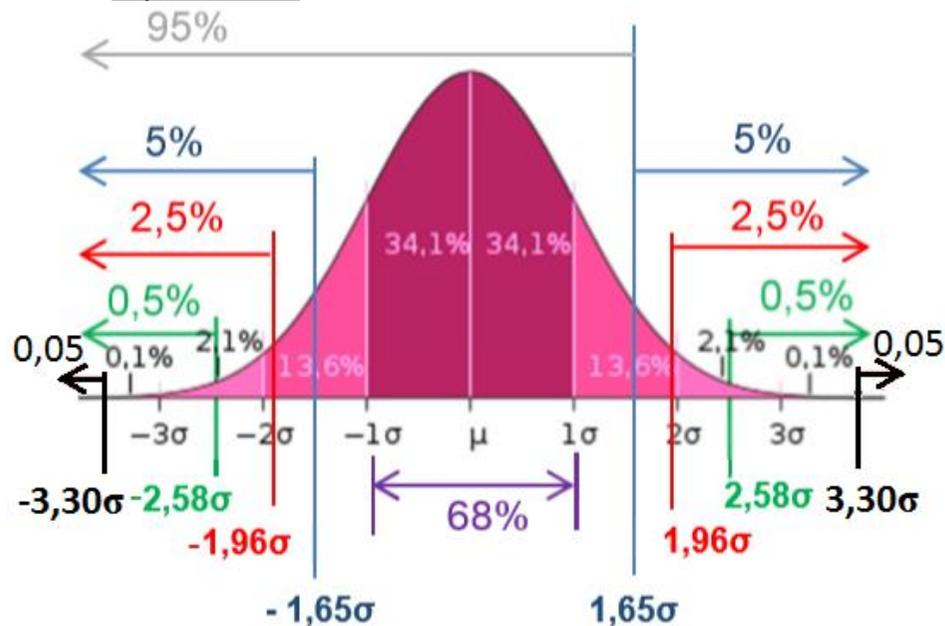
**Fonction de densité :** C'est une courbe en cloche appelée **courbe de Gauss**. On a représenté ici les différents découpage en intervalle des valeurs limites a connaitre. (On lit : il y a 10 chances sur 100 pour que  $X < \mu - 1,65\sigma$  ou  $X > \mu + 1,65\sigma$ , soit 5% du côté gauche et 5% du côté droit).
